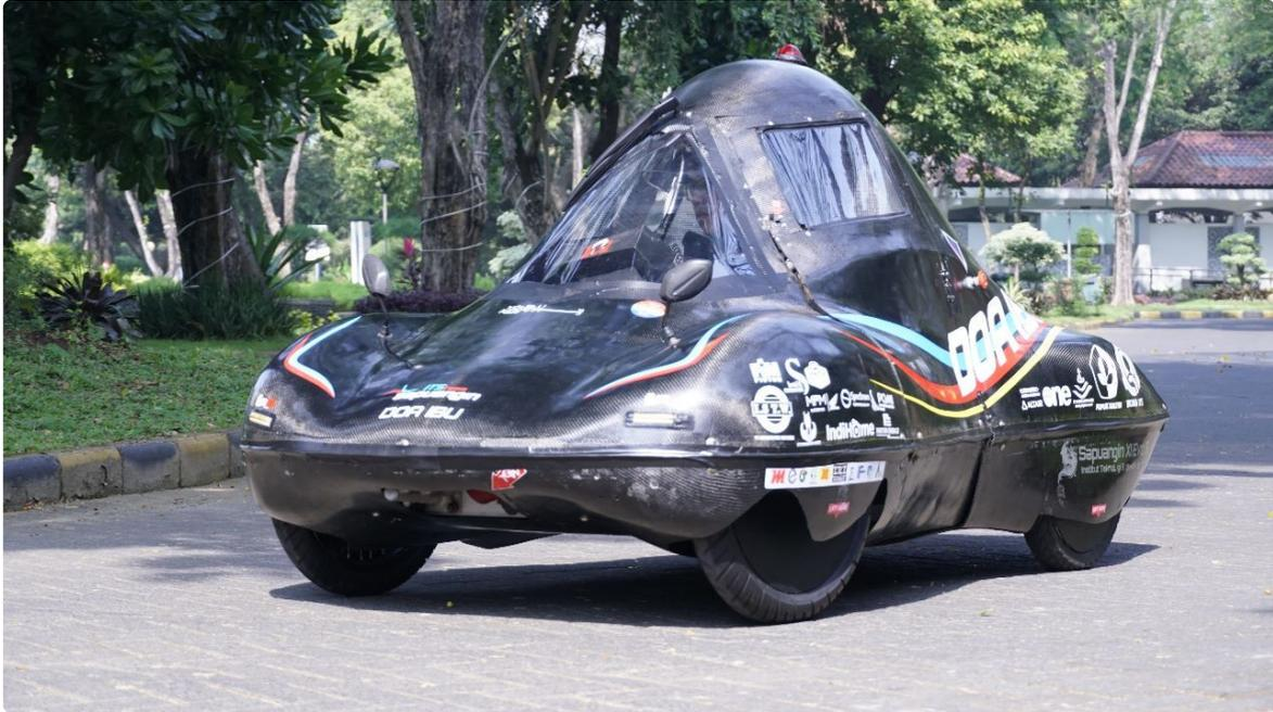
Mobil dengan panjang 2,6 meter, lebar 1,3 meter, dan tinggi 1,1 meter ini dirancang eco-friendly atau ramah lingkungan dan hemat energi. “Salah satu cabang lomba, carbon footprint reduction, mendorong tim kami untuk menjalankan proses hingga hasil produk yang ramah lingkungan,” ungkap mahasiswa Departemen Teknik Mesin ini.
